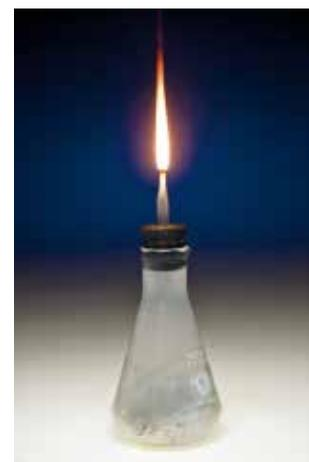
**Figura 2.14** Gas acetileno ardiendo. El acetileno se forma por la reacción de carburo de calcio,  $CaC_2$ , con agua en el matraz.
