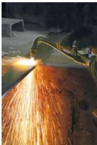
**Figura 2.15** Observación del etino. Cuando está combinado con un exceso de oxígeno, el etino arde con una flama caliente. Por ello se utiliza en los sopletes para soldar o cortar metales.
